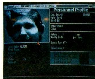
Bild 14. Der Framegrabber von PPS spielt die digitalisierten Bilder gleich in Superbase Professional ein
